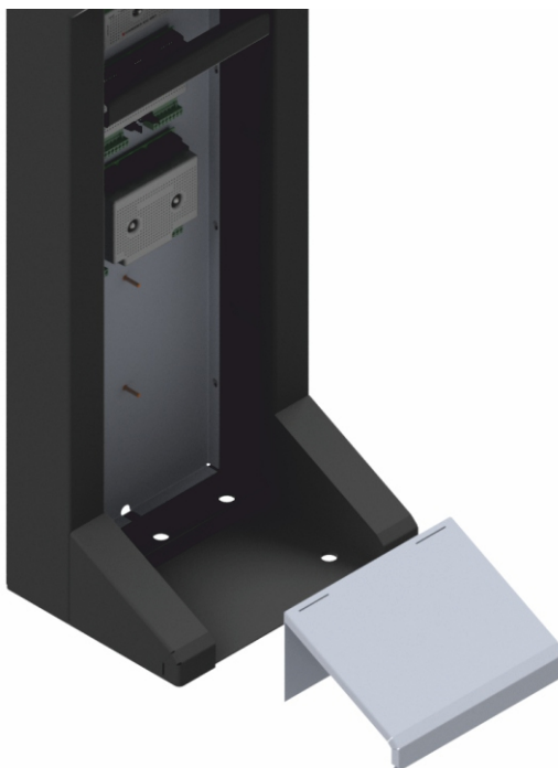
Рисунок 7.4.3 – Демонтаж нижней крышки.
